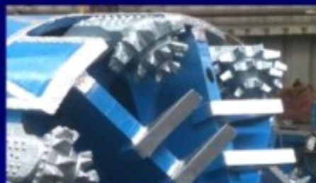
Расширитель с дополнительными резцами для глины
