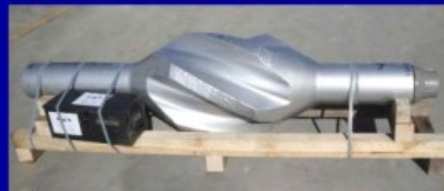
24" спиральные лопасти, отлитые в корпусе
