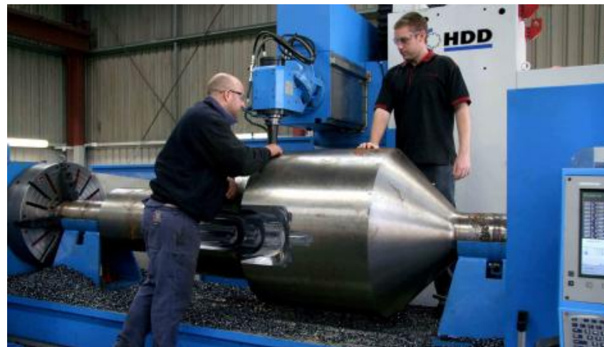
Расширитель 17 ½" X 26" X 36" на фрезерном станке
