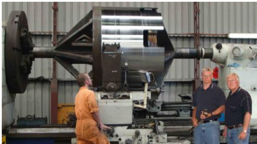
Уплотняющий расширитель (Бочка) 72" на токарном станке
