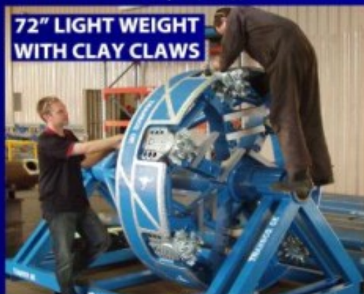
Расширитель 72" легкого веса с резцами для глины
