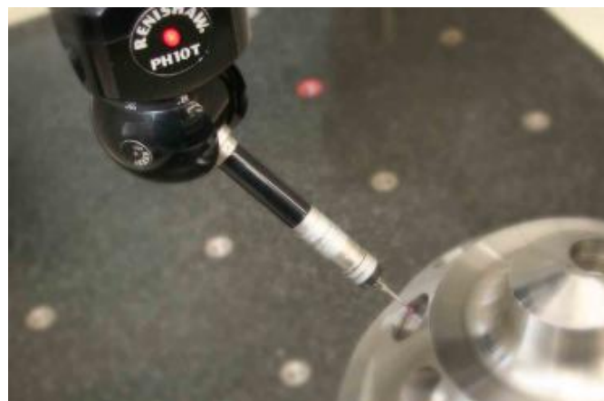
100 % проверка деталей на Координатно - измерительной машине
