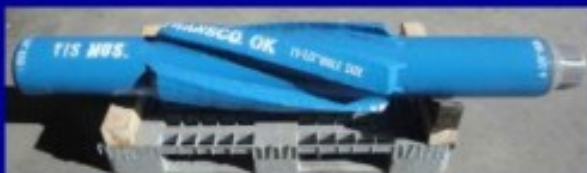
Центратор с выступающими ребрами
