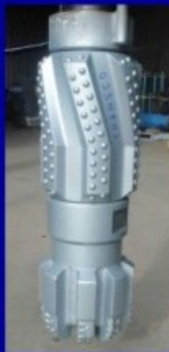
Наддолотный стабилизатор на PDC долоте
