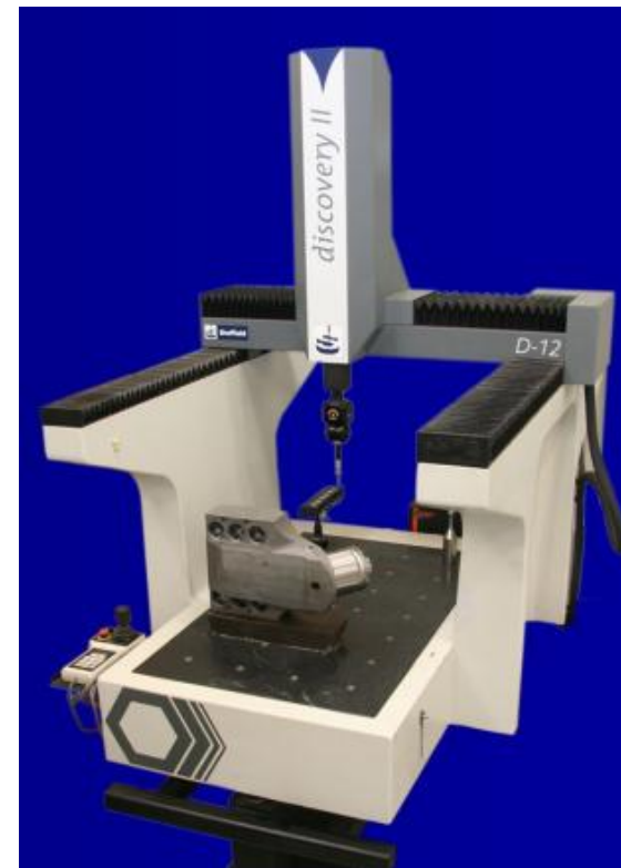
100 % проверка деталей на координатно-измерительной машине
