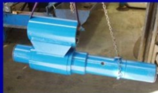
Инструмент для освобождения бурильной колонны от прихвата
