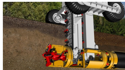
УСТАНОВКА PIPE EXPRESS
