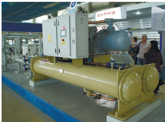
Рис. 2. Тепловой насос мощностью до 2 МВт производства компании YataiGroup, Китай
