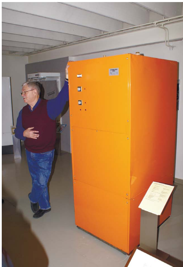
Рис. 5. Первый серийный тепловой насос производства фирмы «THERMIA», Швеция, выпущенный в 1974 г. После 34 лет эксплуатации он сохранил все свои технические характеристики и был помещен в заводской музей
