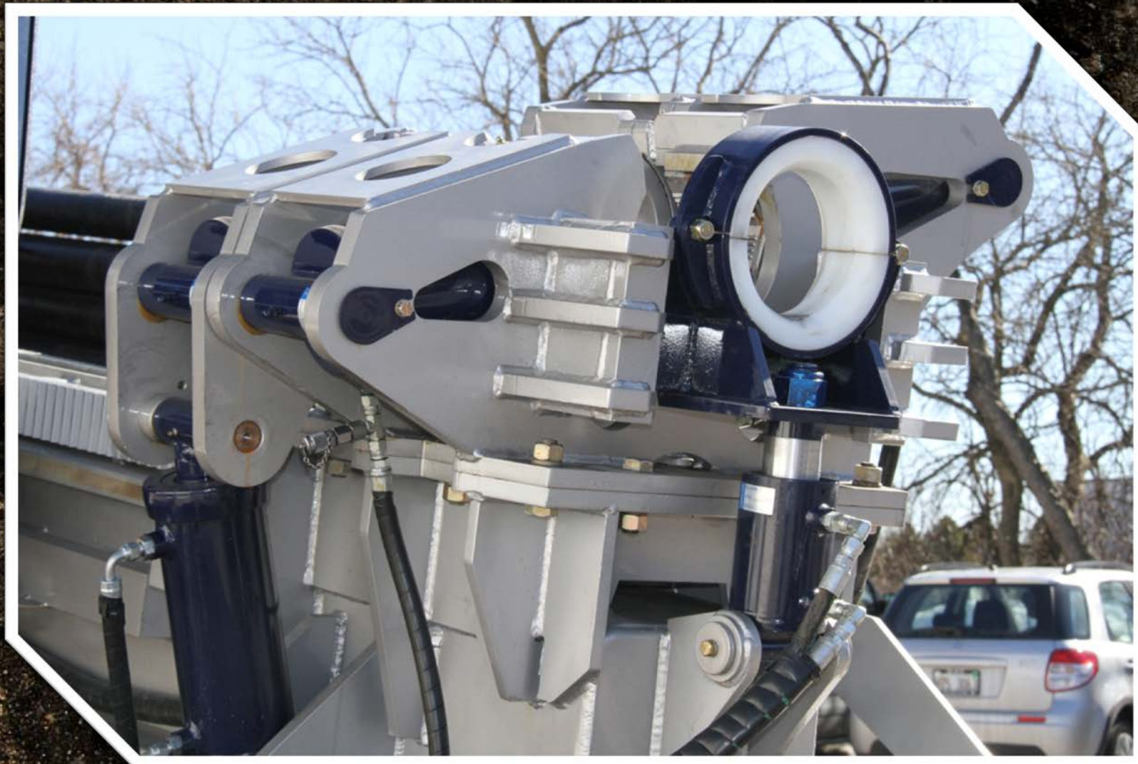
Усиленный механизм раскручивания с центратором штанги
