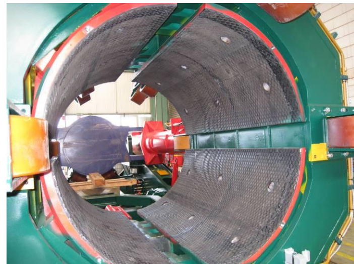
Вставки с вулканизированным покрытием для защиты изоляции
