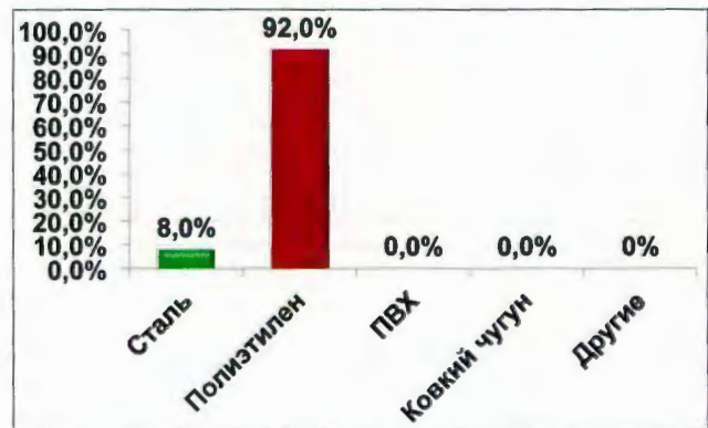
Диаграмма 4. Материалы, из которых были изготовлены установленные по технологии ГНБ трубопроводы в 2014 г.
