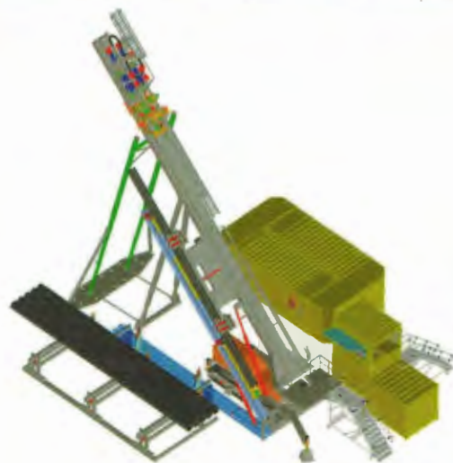
Буровой станок, предназначенный для бурения и капитального ремонта скважин для добычи СВН.
